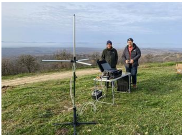
Фиг. 3 Реално използване на стенда при полеви измервания. Вижда се тетраедричната антена и команден пункт
