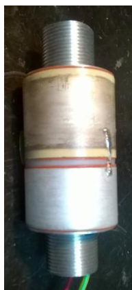
Фиг.3. Хидроакустична антена за диапазона 20\text{kHz} \div 30\text{kHz} , вляво преди херметизация, в центъра херметизирана и в дясно честотната и характеристика
