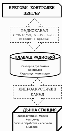
Фиг.2 Архитектурa на системата
