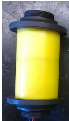
Фиг.3. Хидроакустична антена за диапазона 20\text{kHz} \div 30\text{kHz} , вляво преди херметизация, в центъра херметизирана и в дясно честотната и характеристика
