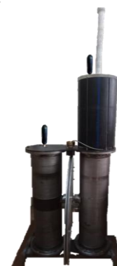
Фиг.1 Многофункционална дънна станция за подводен мониторинг
