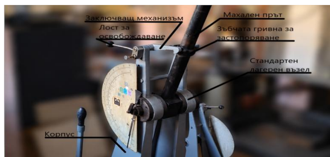
Фигура 1. Стандартен лагерен възел на фабричен чук на Шарпи.
